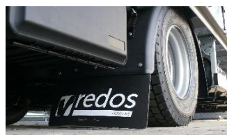
Blotniki z fartuchami antyrozbrzygowymi
