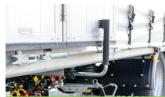
Trzymacze drzwi z aluminium (1) ( 2 )
