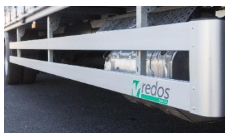
Uchylnie osłony przeciwnajazdowe (aluminiowe, anodowane)
