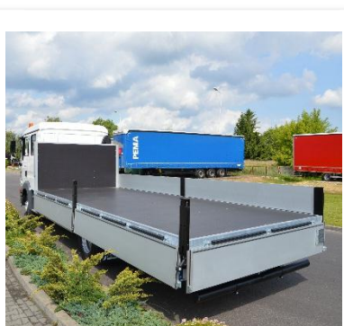
Uchylne osłony przeciwnajazdowe (aluminiowe)
